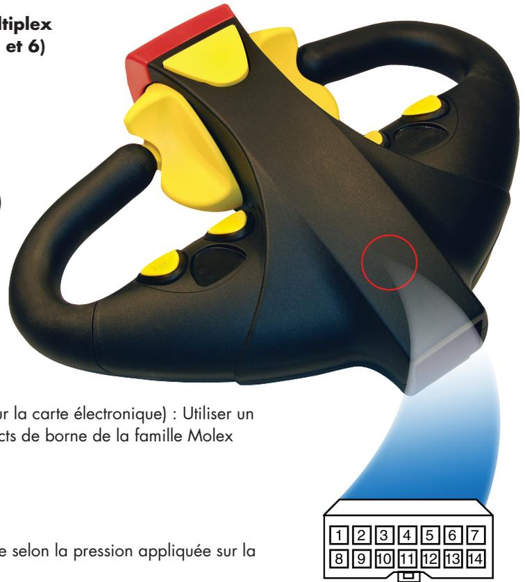
Connecteurs (se trouvent à l'intérieur de la tête de timon sur la carte électronique) : Utiliser un connecteur Molex Mini-Fit, Jr. type 5557D avec des contacts de borne de la famille Molex Mini-Fit type 5556 qui conviennent.
