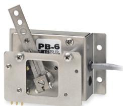
Le boîtier de potentiomètre de Curtis est un module d'accélérateur pour véhicules. Fixé à un bras de levier, le boîtier de potentiomètre fournit au variateur une résistance proportionnelle qui correspond à la vitesse désirée.
