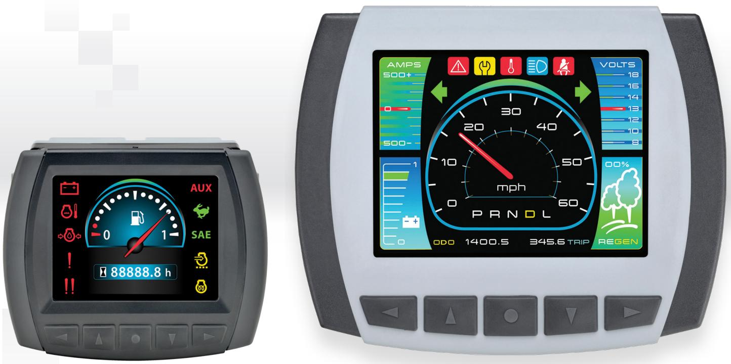
L'affichage Curtis enGage® VI & VII est un instrument programmable à base de microprocesseur compatible avec le bus CAN et doté d'un système d'entrées/sorties complet.
