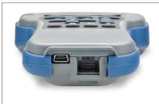
Le port USB permet de se raccorder à un PC pour télécharger des logiciels et transférer des fichiers.
