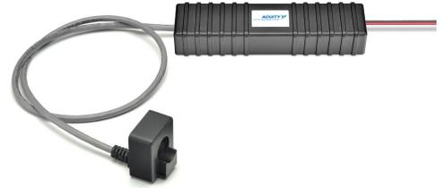
El sistema de monitoreo de la batería Acuity de Curtis es un dispositivo que se monta directamente sobre la batería del vehículo. Mide, registra y transmite datos del rendimiento de la batería a través de la red CAN del vehículo durante la vida útil de la batería.
