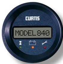
O display de cristal líquido multifunção Curtis Model 840 LCD Multifunction contém 8 caracteres grandes e facilmente legíveis para indicar descarga da bateria (BDI), horímetro e mensagens de erro.
