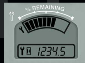
Vor Ort programmierbare Wartungsintervallanzeige
