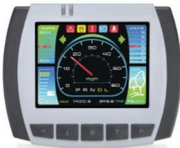
L'enGage® VII de Curtis est un instrument couleur personnalisable à base de microprocesseur qui est compatible CANbus et qui peut être programmé pour surveiller, afficher et commander de nombreuses fonctions du véhicule à partir d'un seul boîtier intégré.
