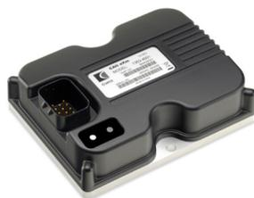
Le module d'expansion d'entrées-sorties CANbus modèle 1352 Curtis est doté de 9 broches d'entrées-sorties, et y compris six drivers de valves proportionnelles. Ce module peut être utilisé pour augmenter la capacité en entrée/sortie des commandes de moteur AC Curtis qui utilisent le langage VCL.
