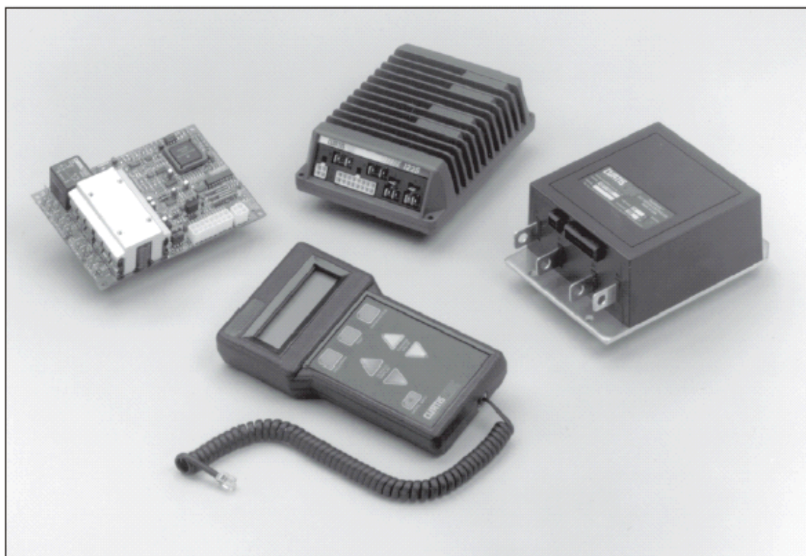
Abb. 1 Curtis PMC 1223, 1225 und 1227 MultiMode TM Impulssteuerungen, mit Programmiergerät 1307.
