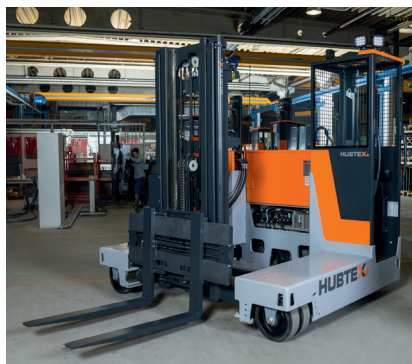
Hubtex MS 27是一款三轮多向侧向装载车，配备立式驾驶室，设计用于搬运托盘和较长的2700kg以下中等重量货物
